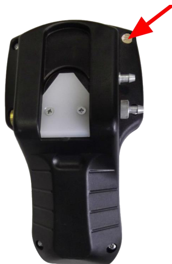
а) расположение пломбы в корпусе (отмечено стрелкой, показана задняя сторона корпуса Сигма-Ех-XXX)
