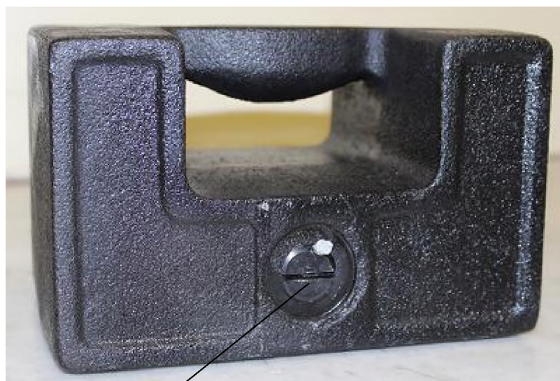
Пробка, закрывающая подгоночную полость от несанкционированного доступа
