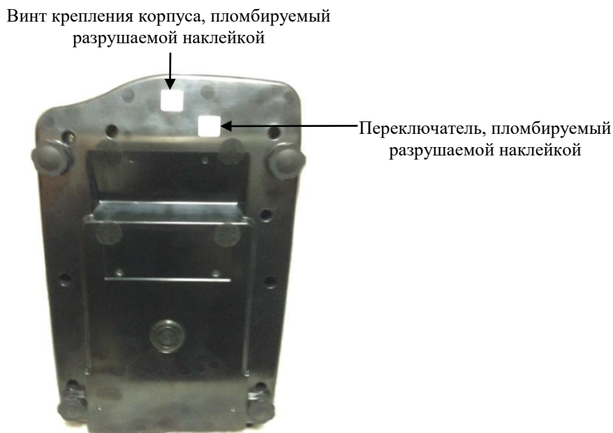
Рисунок 2 - Схема пломбировки весов от несанкционированного доступа.
