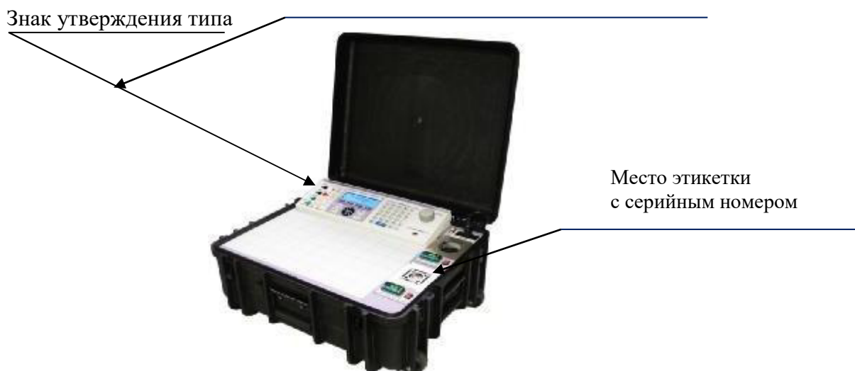
Рисунок 2 – Калибраторы многофункциональные 3041TR, 3050TR, место нанесения знака утверждения типа и серийного номера
