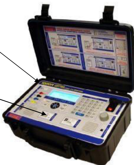
Рисунок 4 – Калибратор многофункциональный 1000TR, место нанесения знака утверждения типа и серийного номера
