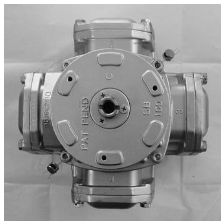
Рисунок 3 – Пример пломбировки счетчика жидкости объёмного типа
