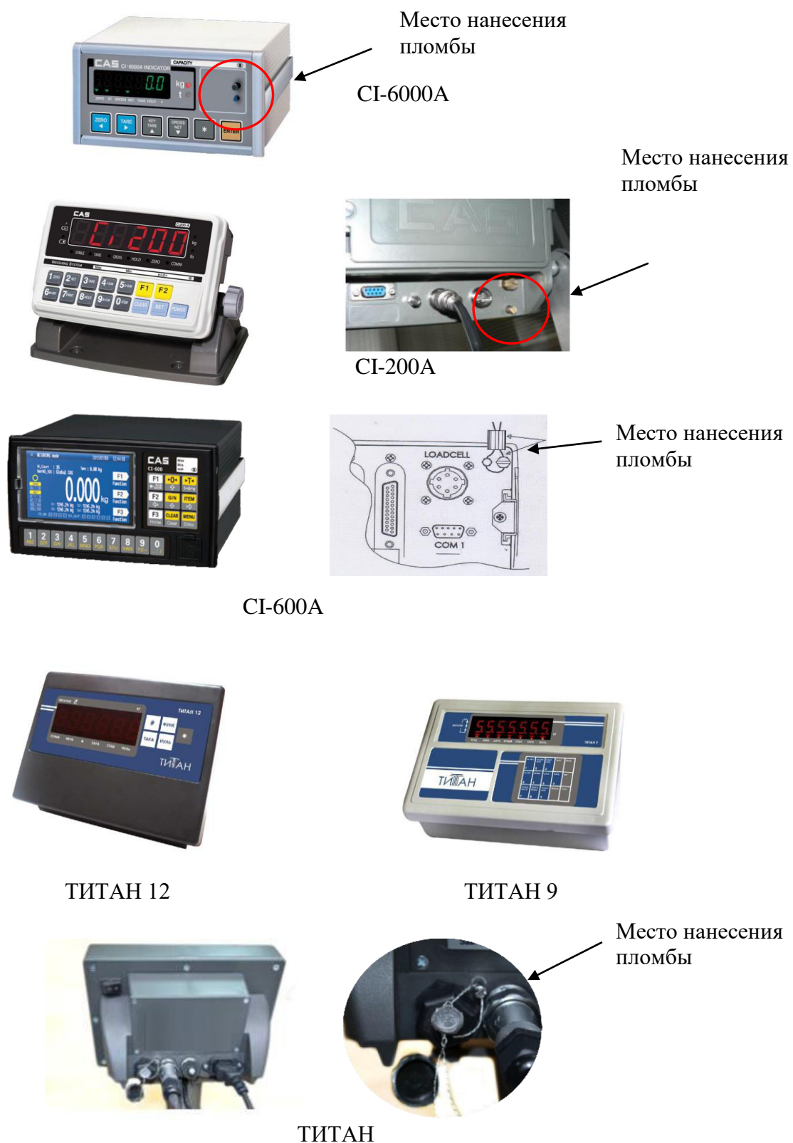
Рисунок 2 – Общий вид и схемы пломбировки индикаторов от несанкционированного доступа
