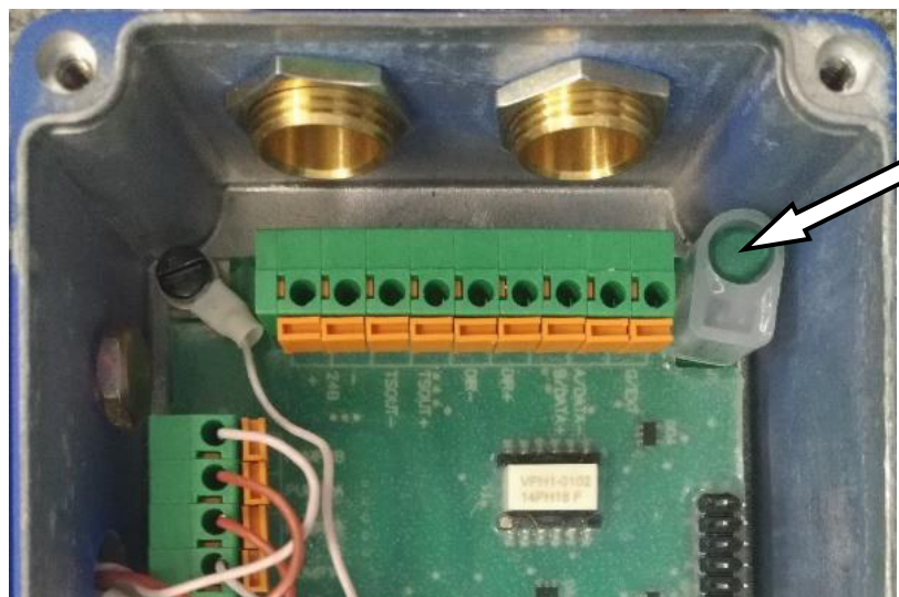
Рисунок 2 – Схема пломбировки от несанкционированного доступа, обозначение места нанесения знака поверки расходомеров-счетчиков электромагнитных «ВЗЛЕТ ППД» исполнений ППД-113, ППД-113*, ППД-213, ППД-Ех
