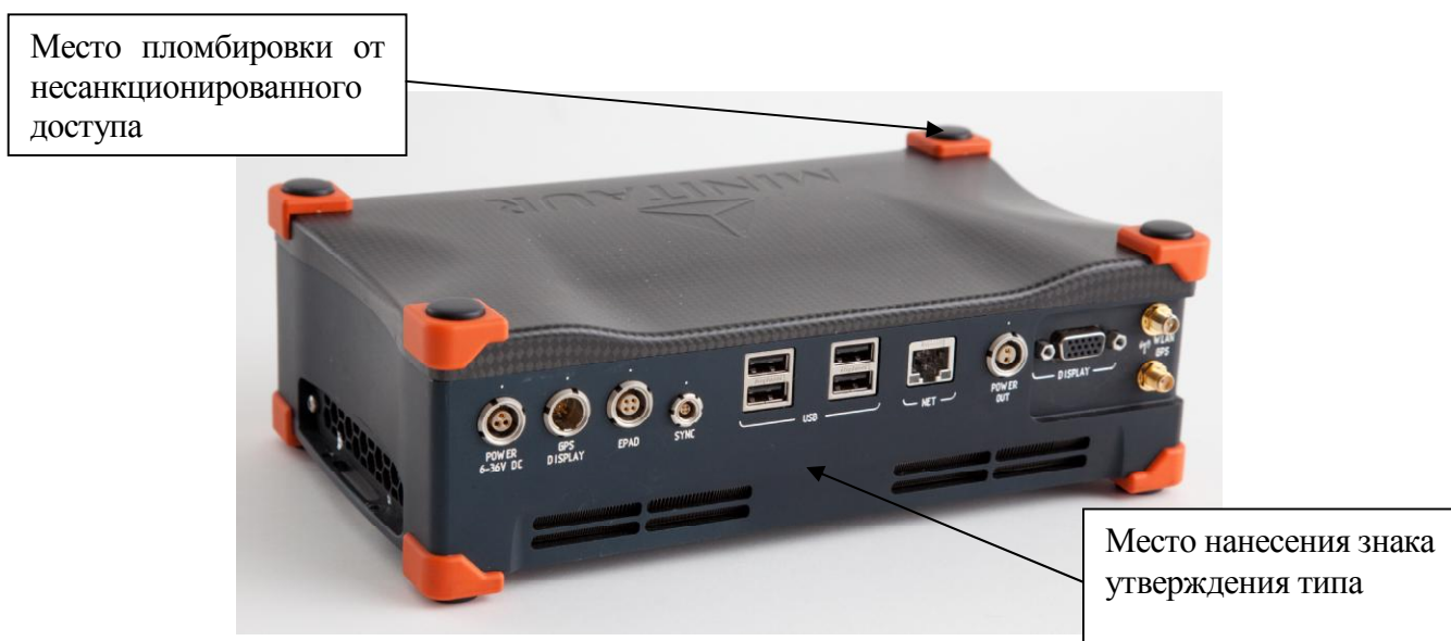
Рисунок 1 – Общий вид и схема пломбировки от несанкционированного доступа измерителя DS Minitaur-100 (версия исполнения до 02.08.2016 года)
