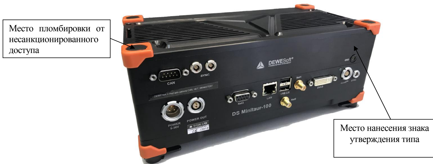
Рисунок 2 – Общий вид и схема пломбировки от несанкционированного доступа измерителя DS Minitaur-100 (версия исполнения после 02.08.2016 года)
