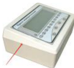
Рисунок 2 - Место для пломбирования узла регулировки прессы гидравлического измерительного ПГИ-500-02
