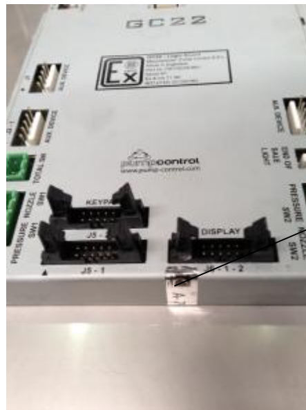
Рисунок 3 - Схема пломбировки крышки контроллера GC22 стикером
