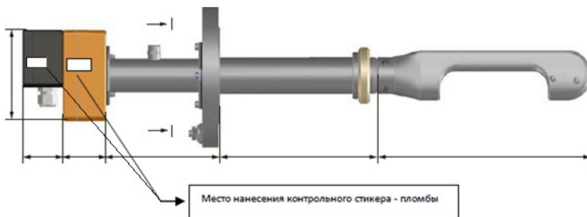
Рисунок 2 – Схема пломбирования. Блок электроники
