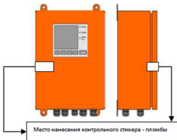
Рисунок 2 – Схема пломбирования. Блок электроники
