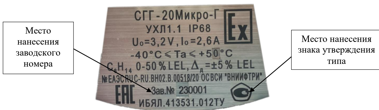
Рисунок 2 – Общий вид таблички фирменной с указанием места нанесения знака утверждения типа и заводского номера
