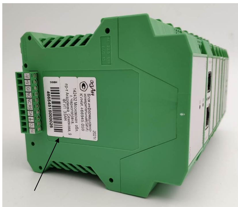
Рисунок 2 - Обозначение места нанесения заводского номера БИИ, знаков поверки и утверждения типа
