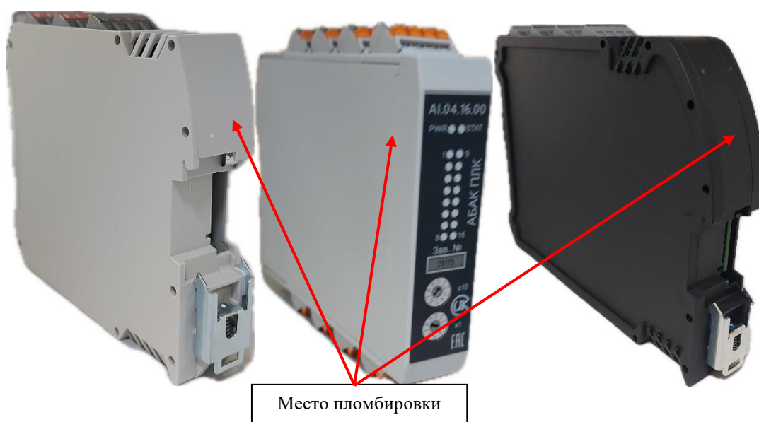
Рисунок 4 – Схема пломбировки модулей АБАК ПЛК
