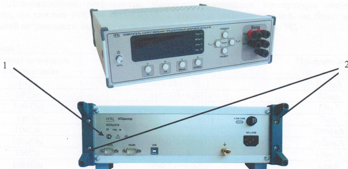
1- место нанесения знака утверждения типа 2 - места пломбировки от несанкционированного доступа Рисунок 1 - Внешний вид измерителя цифрового ИСПЦ-01В
