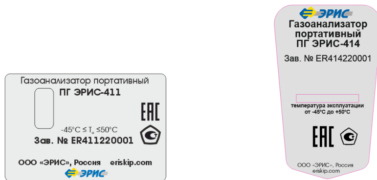
Рисунок 1 – Маркировочные таблички газоанализаторов портативных ПГ ЭРИС-411, ПГ ЭРИС-414 с указанием заводского номера и знака утверждения типа
