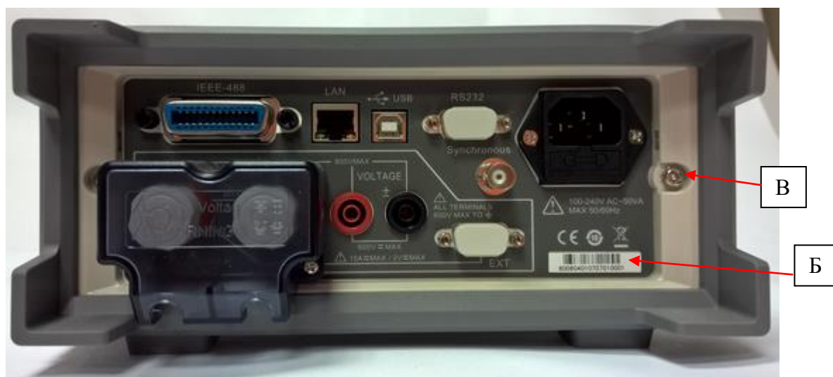
Рисунок 2 – Вид задней панели измерителей, место нанесения серийного номера (Б) и схема пломбировки от несанкционированного доступа (В)
