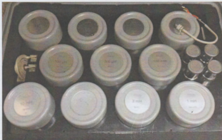
Рисунок 1 - Внешний вид мер индуктивности P593M
