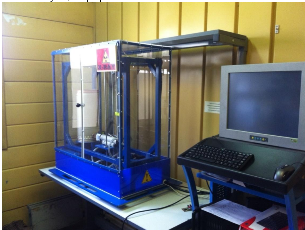
Рисунок 1 - Толщиномеры покрытий специализированные рентгенфлуоресцентные в составе технологического оборудования РТВК-1КР. Общий вид
