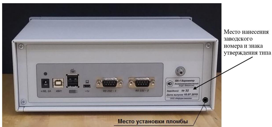
Рисунок 2 — Схема пломбирования барометров БА-1
