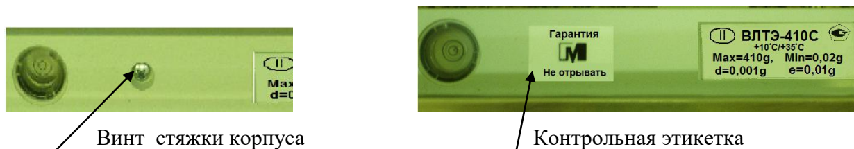
Рисунок 2 - Схема пломбирования от несанкционированного доступа
