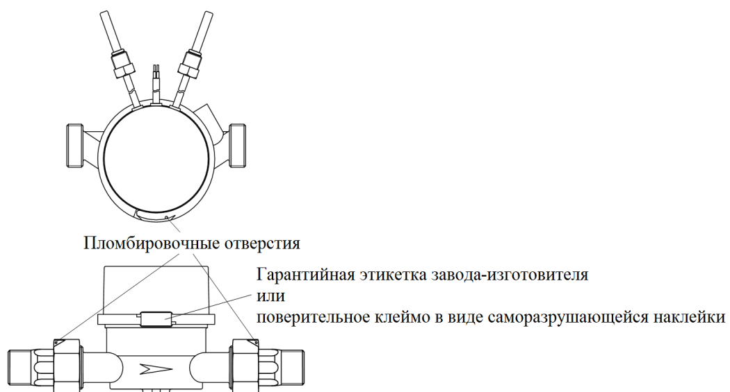
Р и с у н о к 2 – Схема пломбировки от несанкционированного доступа, обозначения места нанесения знака поверки на счетчики тепла Гефест 06.V1.I, Гефест 06.V1.R, Гефест 06.V1.M, Гефест 06.V1.F, Гефест 15.V2.I, Гефест 15.V2.R, Гефест 15.V2.M, Гефест 15.V2.F
