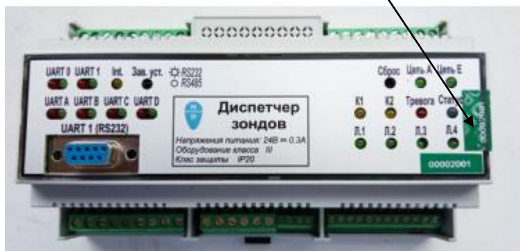
Рисунок 7 – Общий вид блока ДЗ и место пломбировки
