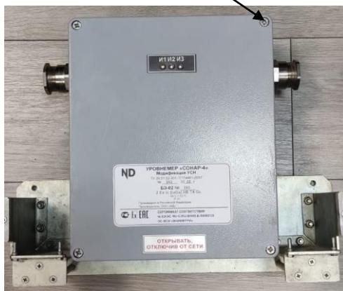
Рисунок 10 – Общий вид блока БЭ-02 и место пломбировки
