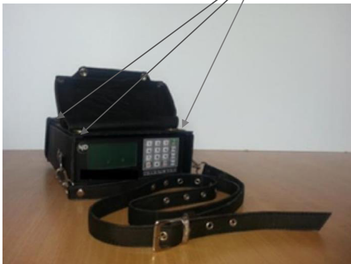
Рисунок 5 – Общий вид блока БИВ-1 и место пломбировки
