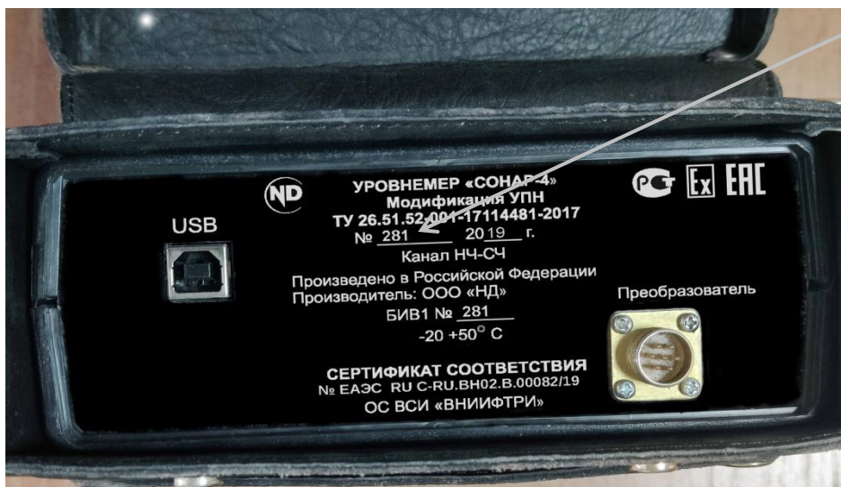
Рисунок 11 – Место нанесения заводского номера для модификации УПН
