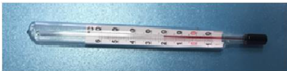
Рисунок 2 - Общий вид термометров складских ТС-7А, ТС-7АМ
