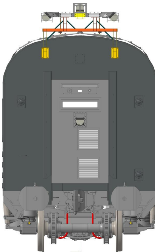
Рисунок 2 - Схематичное расположение Систем скоростного и высокоскоростного трехмерного сканирования «Габарит-М» на вагоне
