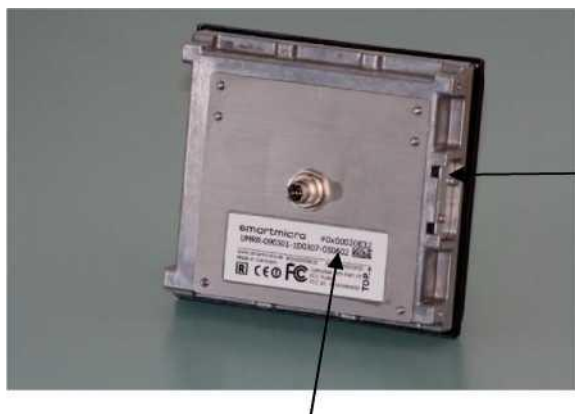
Рисунок 2 – Внешний вид составной части комплекса (блок радиолокационный, тип UMRR)
