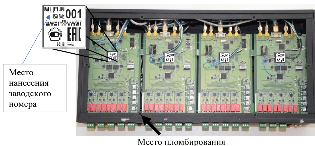
Рисунок 2 - Общий вид и место опломбирования от несанкционированного доступа модулей МЦП-Б и МЦП-БД
