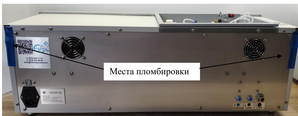
Рисунок 2 – Места пломбировки анализаторов
