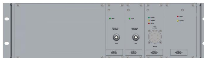
Рисунок 10 – Электронный блок резервированного блока питания повышенной надежности (вид сзади)
