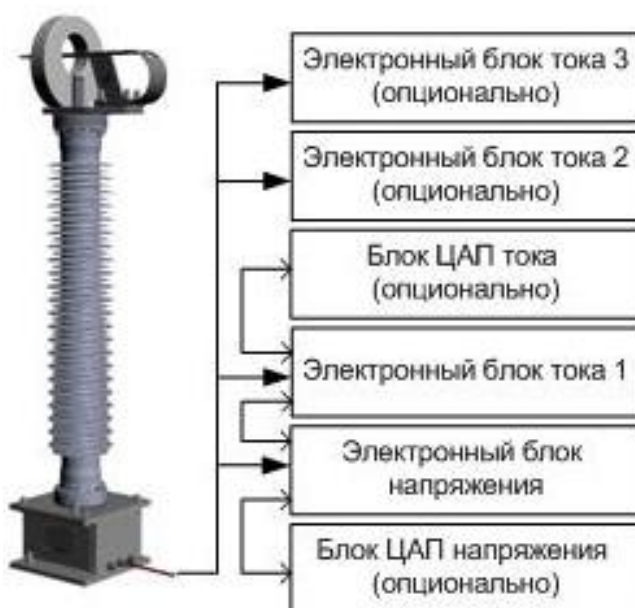
Рисунок 4 – Схема соединения блоков ТТНК
