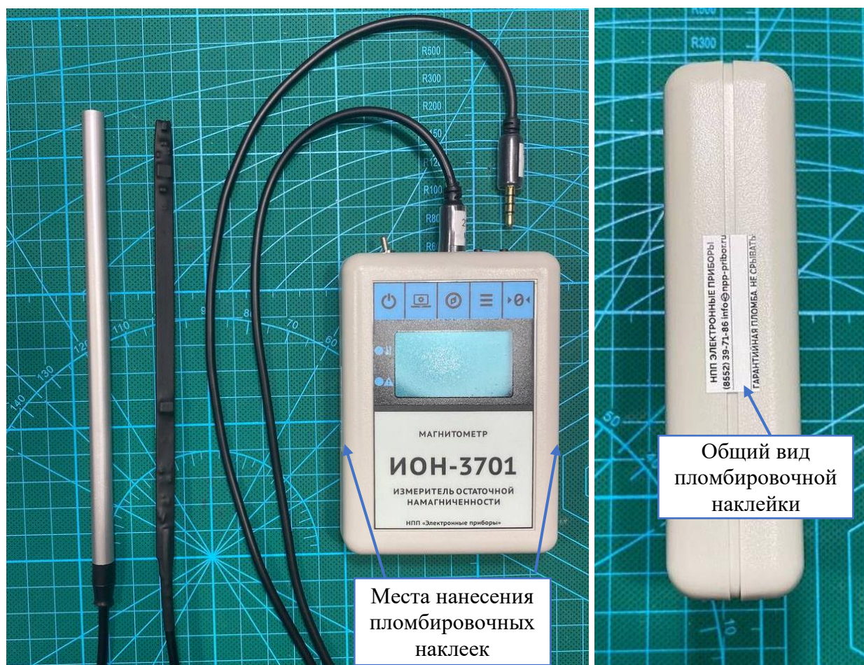
Рисунок 2 – Датчики на 50 (200) мТл, 1600 мТл; Схема пломбировки от несанкционированного доступа
