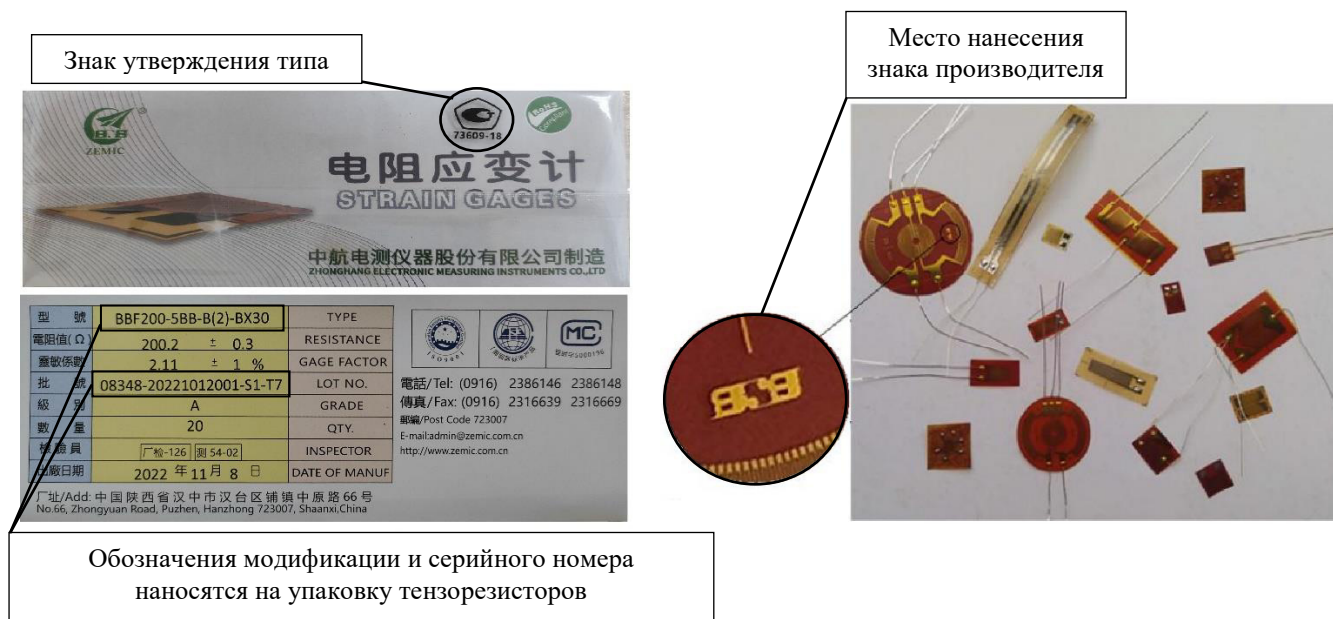
Рисунок 1 - Общий вид тензорезисторов, обозначение мест нанесения серийных номеров, цифровых обозначений модификаций, знака производителя и знака утверждения типа
