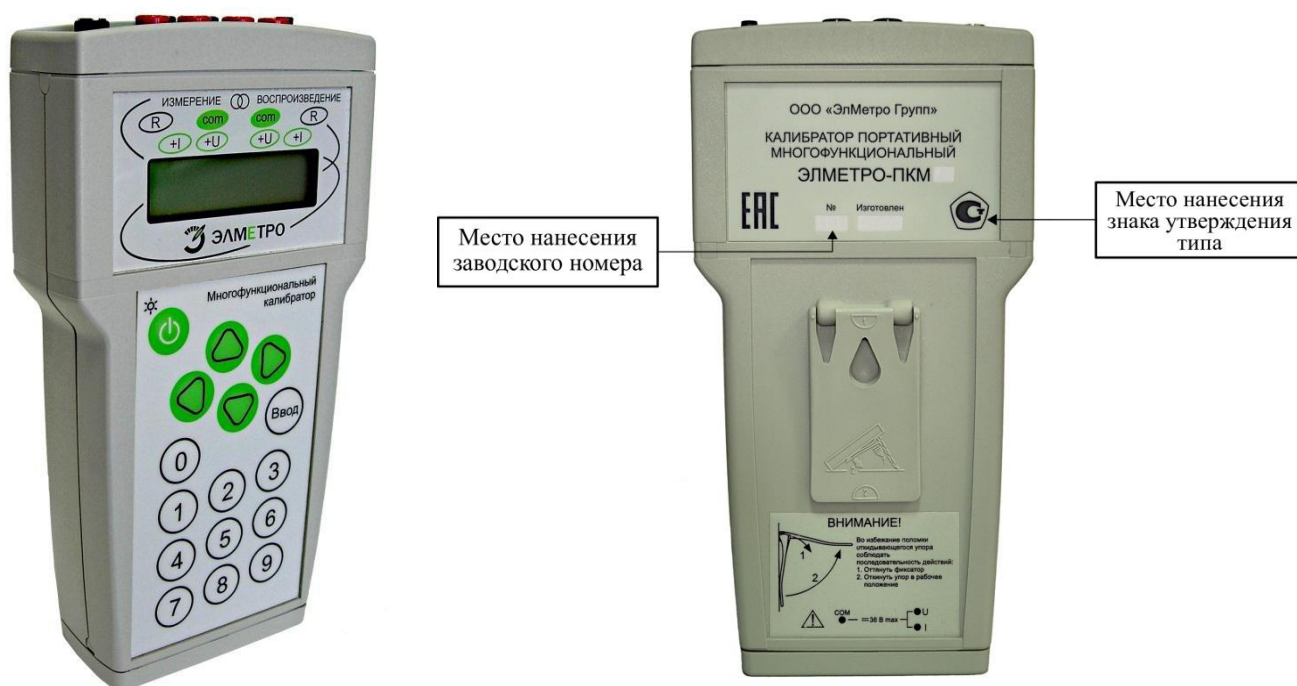
Рисунок 1 – Общий вид калибраторов, обозначение мест нанесения заводского номера и знака утверждения типа
