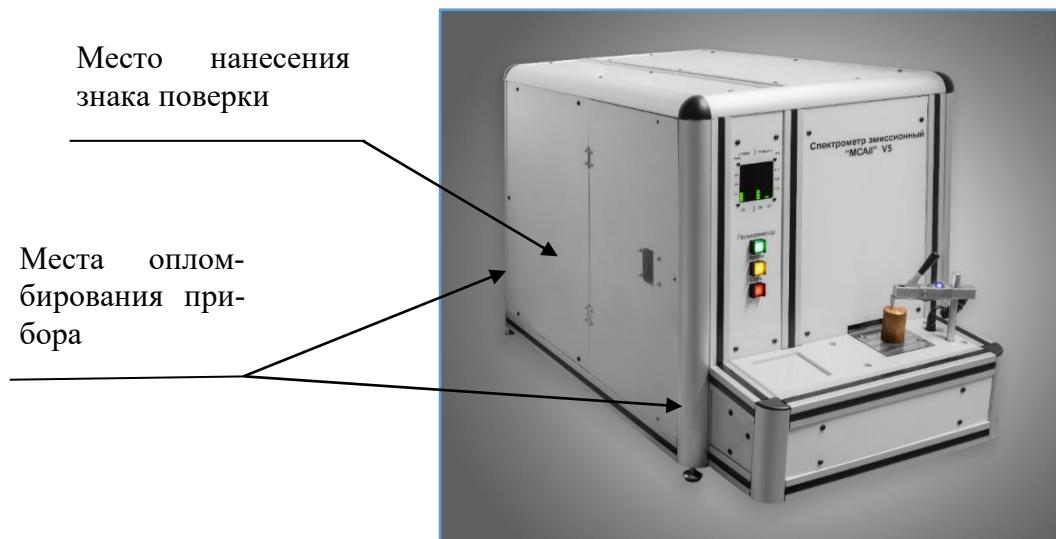
Спектрометры эмиссионные МСА модификаций MCAI V5, MCAI V5 R, MCAI V5 Воздух, MCAI V5 Воздух R, MCAII V5, MCAII V5 R, MCAII V5 Гибрид, MCAII V5 Гибрид R, MCAIII
