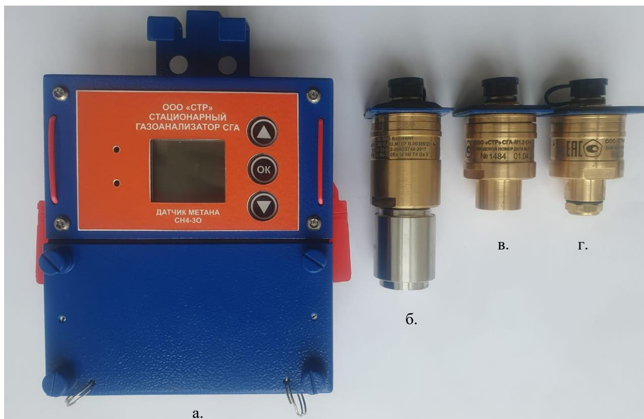
Рисунок 1 – Внешний вид газоанализаторов (а – блок индикации СГА-М1.1; б, в – блок датчиков СГА-М1.2; г – блок датчиков СГА-М2.2)
