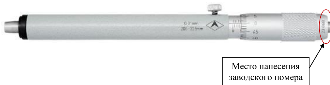
Рисунок 4 - Общий вид нутромеров модели 710 с указанием места нанесения заводского номера
