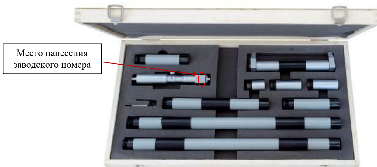
Рисунок 2 – Общий вид нутромеров модели 708 с указанием места нанесения заводского номера
