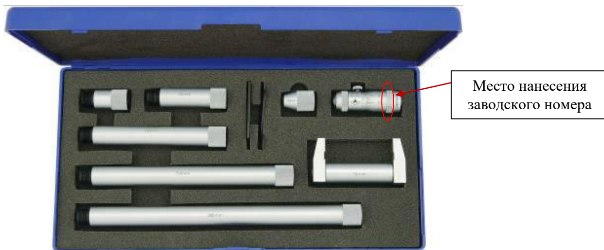
Рисунок 1 – Общий вид нутромеров модели 707 с указанием места нанесения заводского номера
