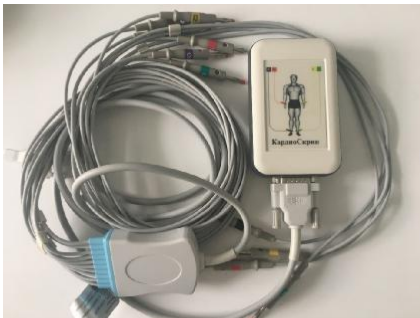
Рисунок 1 – Общий вид системы для скрининговой экспресс-оценки состояния сердца «КардиоСкрин»
