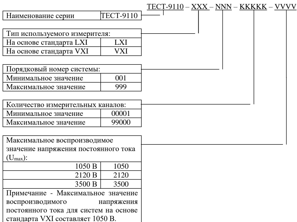
Рисунок 1 – Обозначение модификаций систем
