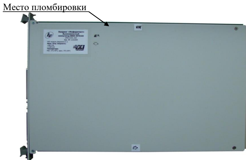
Рисунок 4 – Схема пломбировки функциональных модулей
