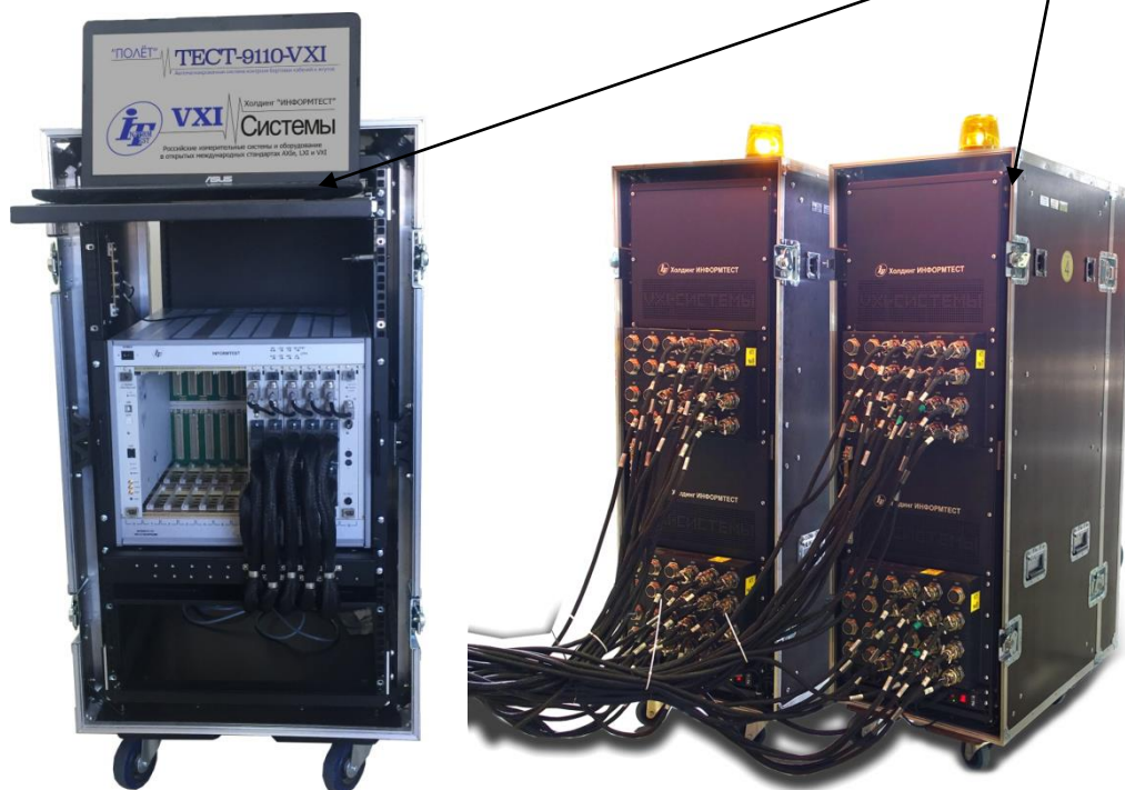
Рисунок 3 – Внешний вид систем на основе стандарта VXI, включающих до 4600 каналов (слева) и более 4600 каналов (справа)
