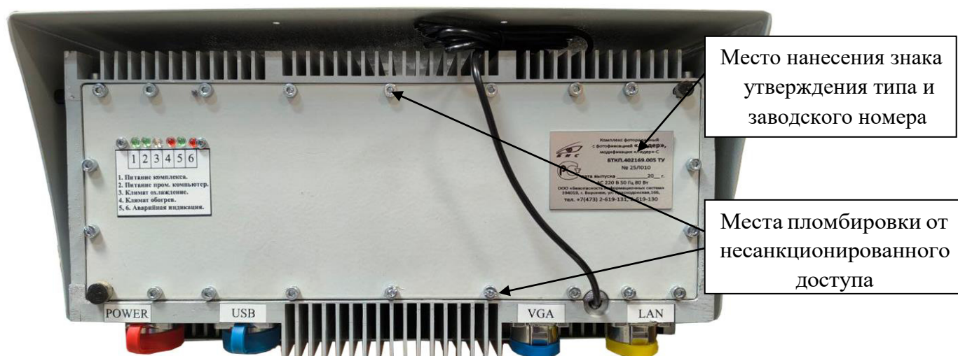
Рисунок 3 - Места пломбирования и нанесения знака утверждения типа и заводского номера
