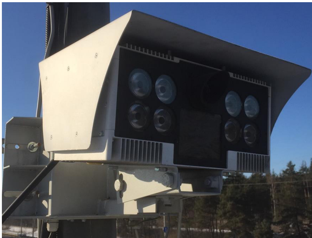
Рисунок 1 – Общий вид комплексов в модификации «Лидер»-С с кронштейном со встроенным блоком питания
