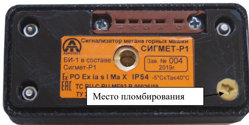
Рисунок 2 – Сигнализаторы метана горных машин Сигмет-Р1, схема пломбирования от несанкционированного доступа посредством мастики.
