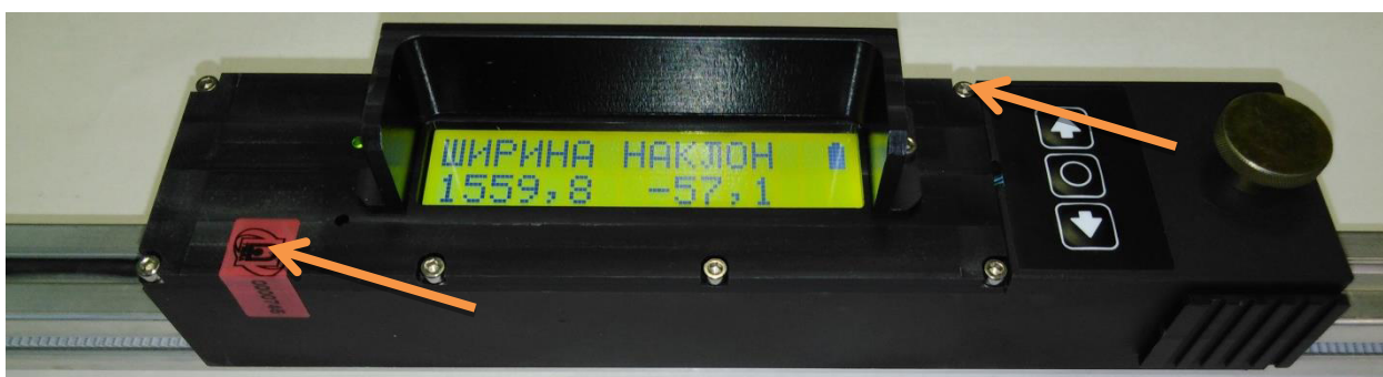
Рисунок 4 – Места пломбирования ШЭП (указаны стрелками)
