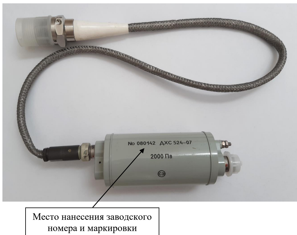
Рисунок 1 – Общий вид датчика ДХС 524 с указанием мест нанесения заводского номера и маркировки
