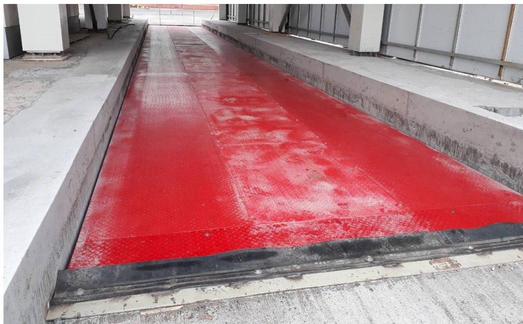
Рисунок 2 — Общий вид ГПУ для взвешивания ТС в движении, а также в режиме статического взвешивания (пример)
