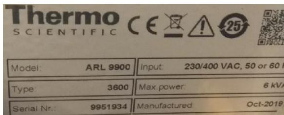
Рисунок 1 – Образец маркировочной таблички, где Model: ARL 9900 – тип спектрометра; Type: 3000 – тип для мощности рентгеновской трубки
