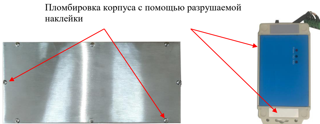
Рисунок 4 — Схема пломбирования весоизмерительного прибора СВ-06 и электронного устройства преобразования и передачи сигналов датчиков
