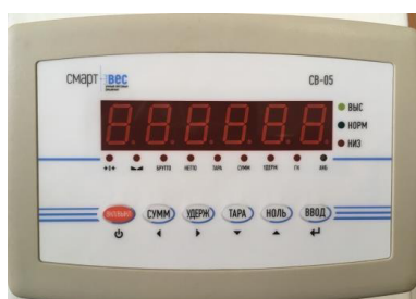
Рисунок 2 — Внешний вид и схема пломбирования весоизмерительного прибора СВ-05
