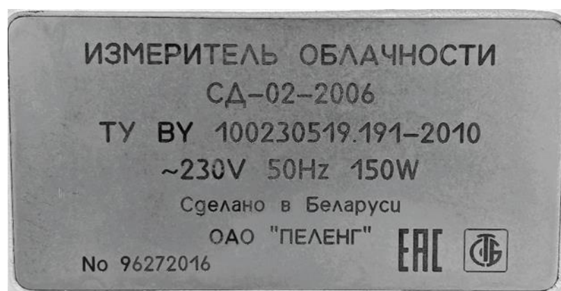
Рисунок 2 – Бирка измерителей облачности СД-02-2006
