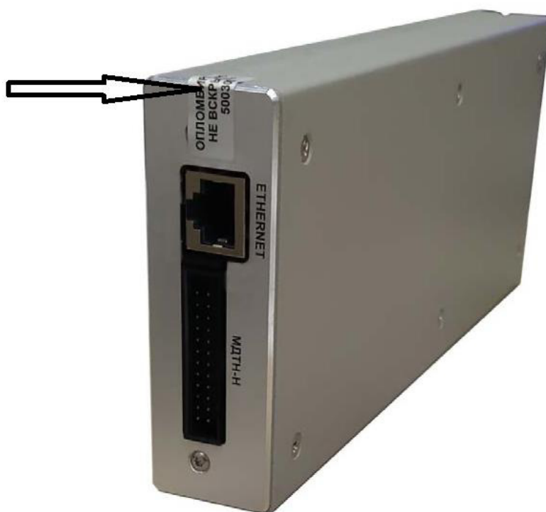
Рисунок 6 - Места пломбирования от несанкционированного доступа датчика напряжения ДН-3П
