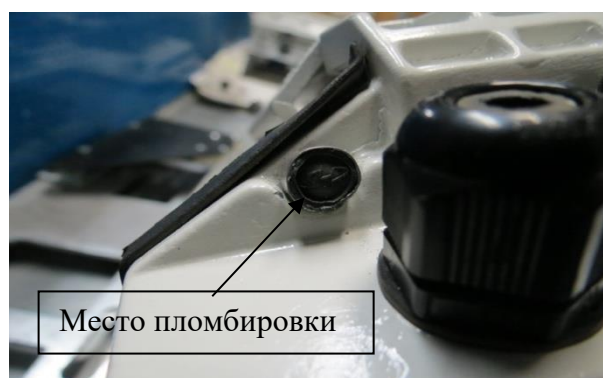
Рисунок 4 – Схема пломбировки видео модуля
