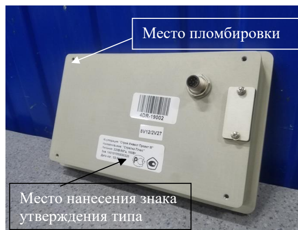
Рисунок 6 – Схема пломбировки и место нанесения знака утверждения типа на 4D модуль
