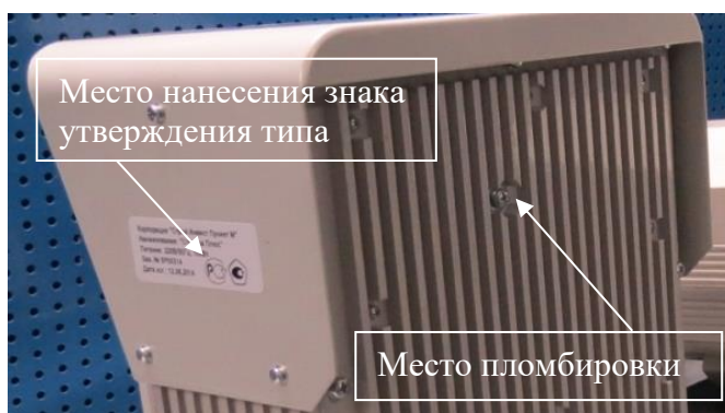
Рисунок 3 – Схема пломбировки RD модуля и место нанесения знака утверждения типа
