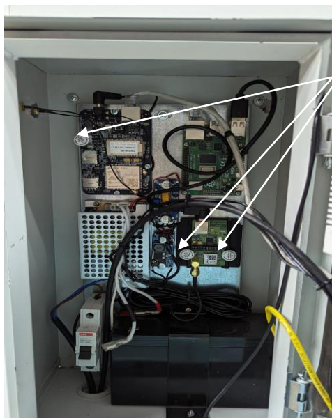
Рисунок 2 – Схема пломбировки комплексов от несанкционированного доступа
