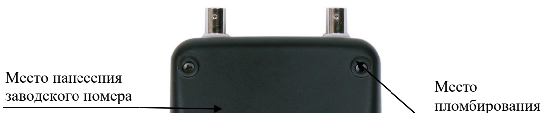
Рисунок 3 – Места нанесения заводского номера, пломбировки от несанкционированного доступа на панели прибора
