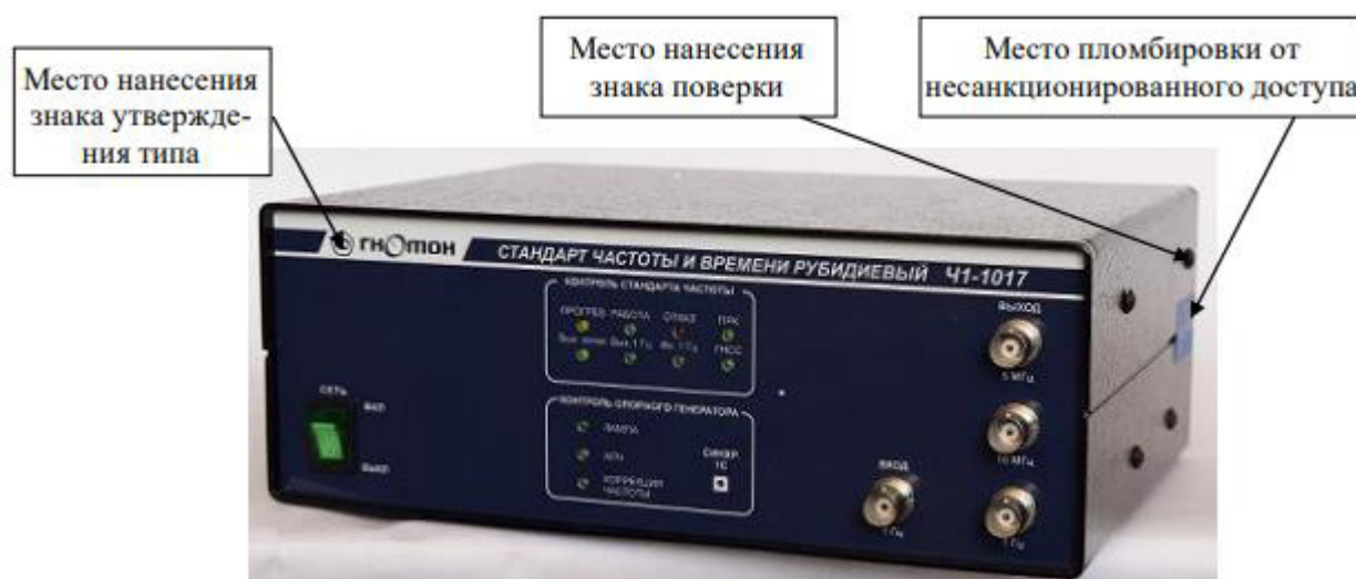
Рисунок 3 - Общий вид стандартов (изготовленных с 2023 года) с указанием мест нанесения знака утверждения типа, знака поверки и пломбировки от несанкционированного доступа
