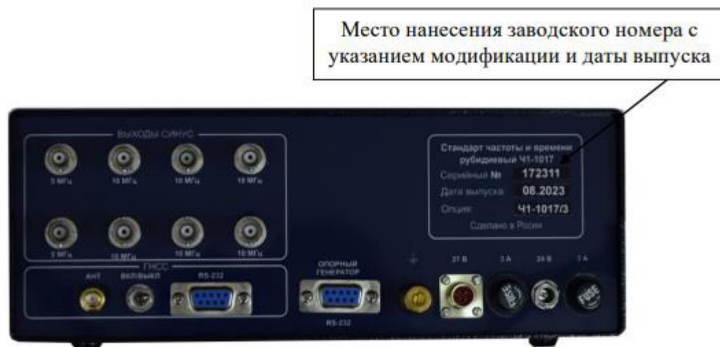
Рисунок 4 – Задняя панель стандартов (изготовленных с 2023 года) с указанием мест нанесения заводского номера, модификации стандарта и даты выпуска
