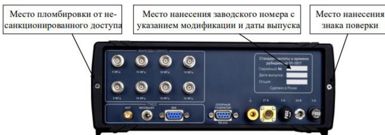
Рисунок 2 - Задняя панель стандартов (изготовленных до 2023 года) с указанием мест пломбировки от несанкционированного доступа, нанесения знака поверки и заводского номера
